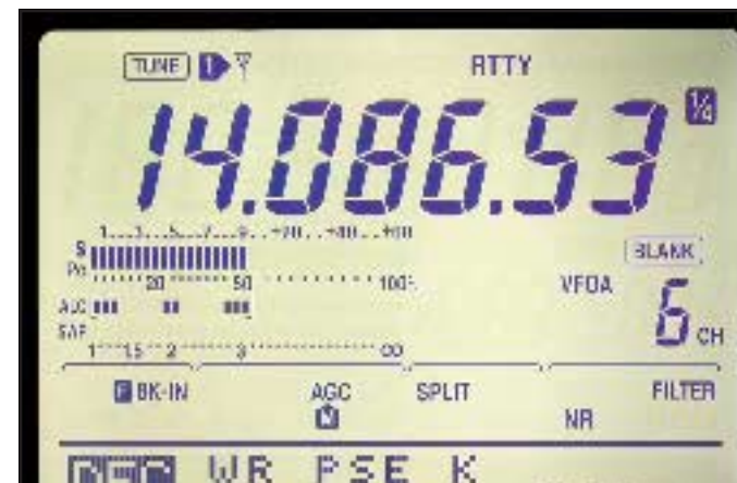
RTTY wird empfangsseitig sogar direkt auf dem Display decodiert – hier ein QSO zwischen einem rumänischen und einem spanischen OM. Man beachte auch die ALC-Anzeige (Mitte links), die Mark und Space für die exakte Abstimmung zeigt.
